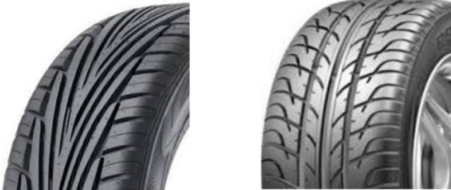
Dubina šare za letnji pneumatik minimalno 1,6 mm ili do indikatora istrošenosti, ako postoji indikator
