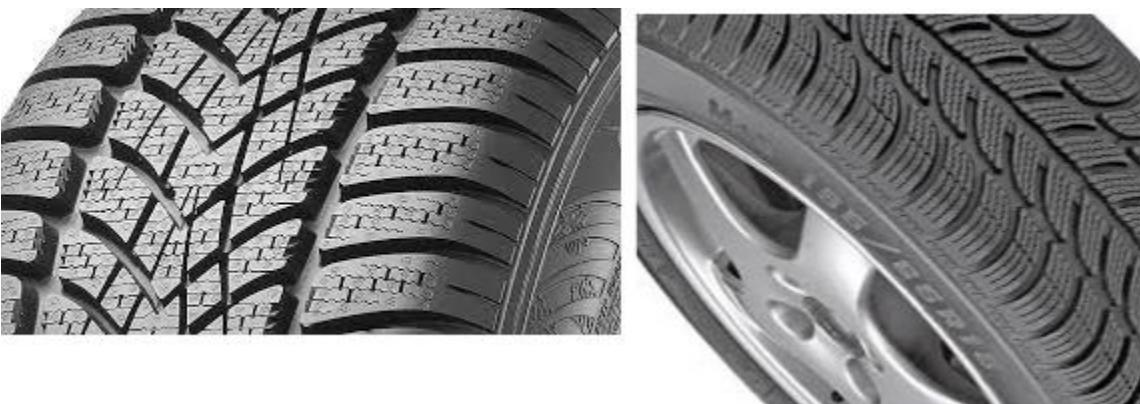
Dubina šare kod zimskih guma minimalno 4 mm ili do indikatora istrošenosti, ako postoji indikator
